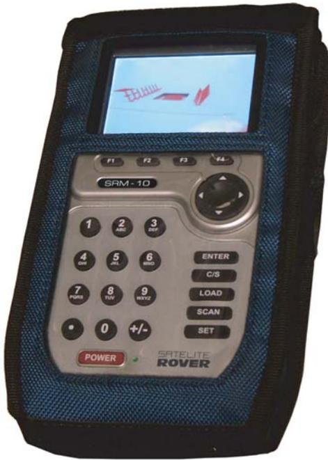
Medidor de campo portátil que implementa todas las mediciones habituales en una instalación de TV digital terrestre. Su tamaño, peso y robustez, unido a su pantalla a color y autonomía lo hacen idóneo como equipo de campo. Se incluye funda, cargador de red, cargador de coche y aplicación de PC para gestión de canalizaciones.
