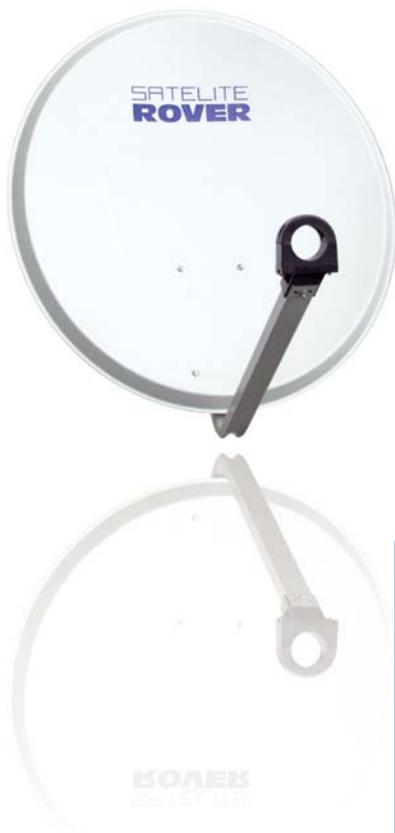
Parábolas offset construidas en chapa electro-galvanizada y pintadas en polvo poliéster que confiere una alta resistencia al salitre y a la corrosión tanto a la antena como a los elementos de fijación. Resistencia al viento superior a 150 Km/h. Se presentan en tres monturas diferentes:
